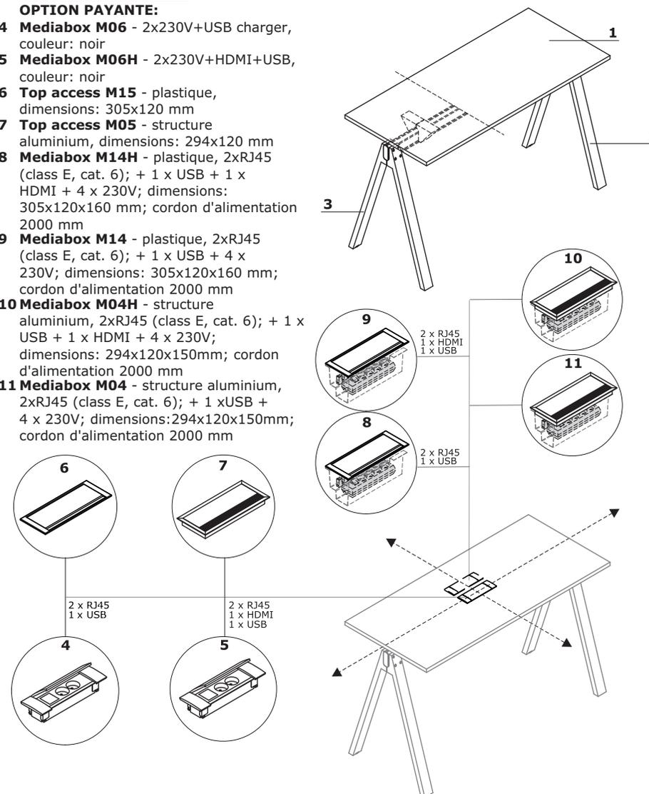
Remarque : les top access M15, M05 Mediabox M06 et Mediabox M06H sont centrés sur le plan de travail ; les Mediabox M14, M14H, M04, M04H sont excentrés.
