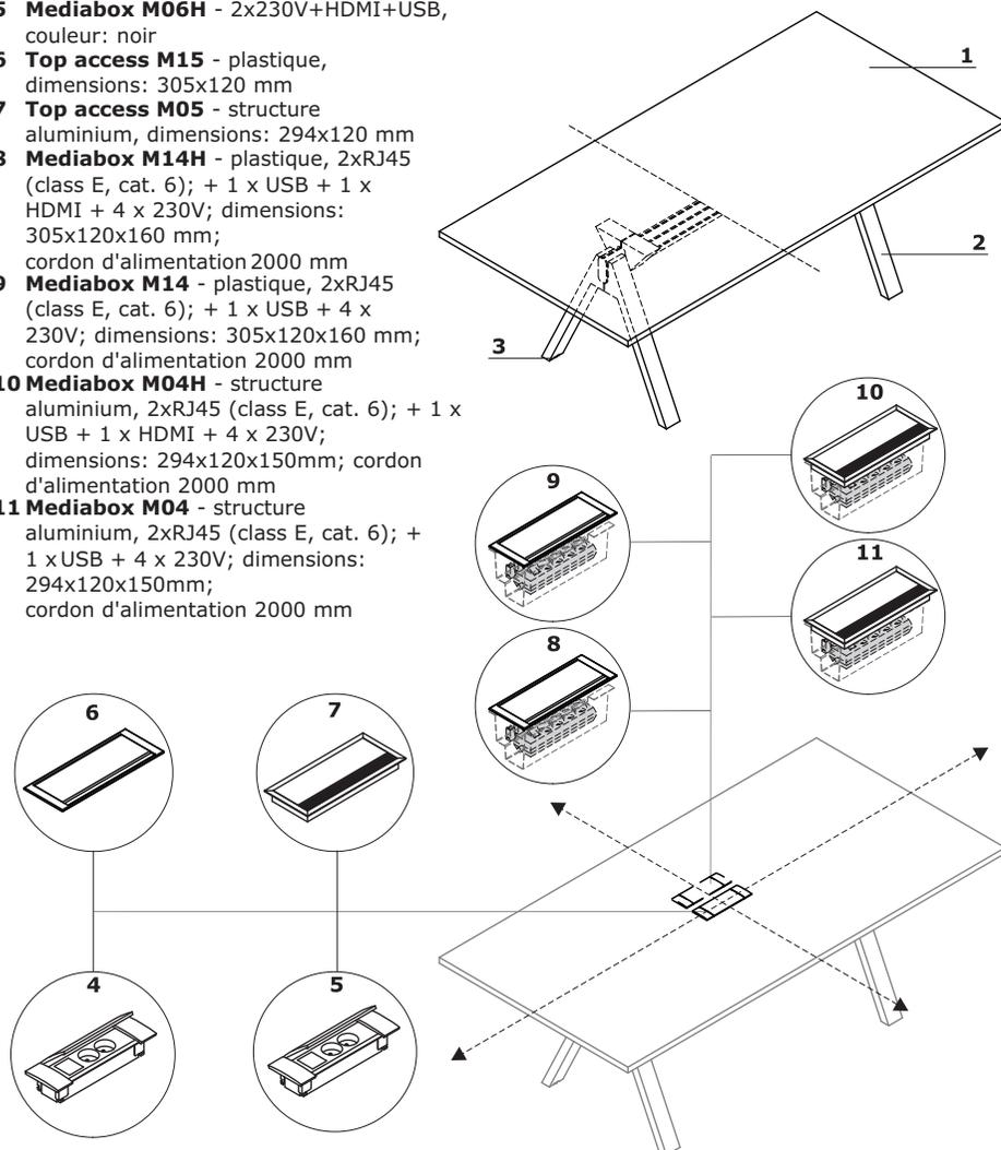
Remarque : les top access M15, M05 Mediabox M06 et Mediabox M06H sont centrés sur le plan de travail ; les Mediabox M14, M14H, M04, M04H sont excentrés.
