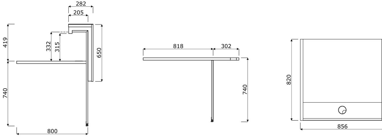
**Abmessungen - Monitorboden(mm)**
