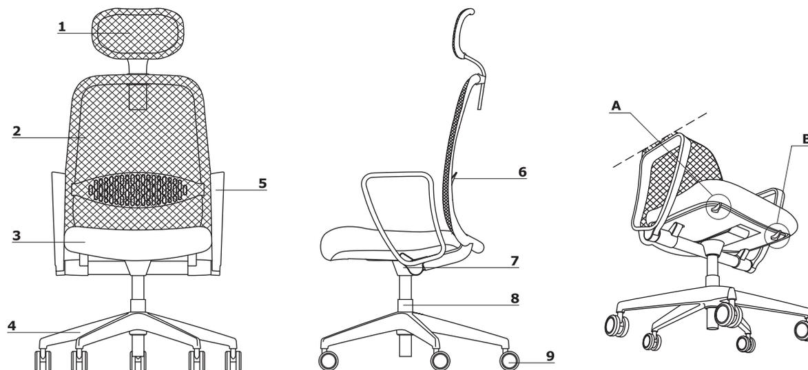
A: ajuste de altura del asiento, B: bloqueo del respaldo;
